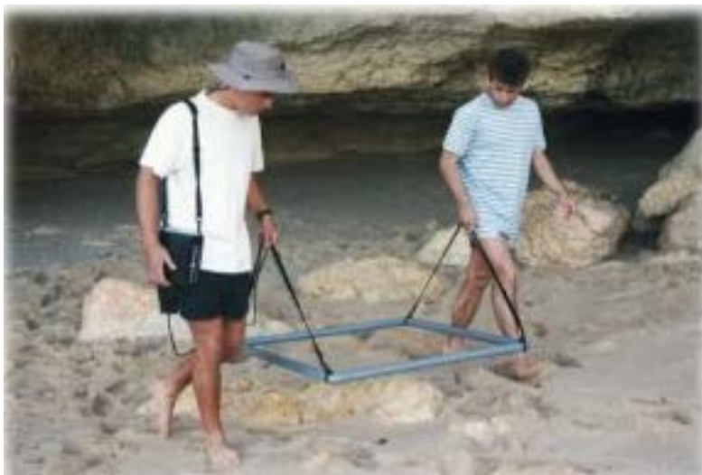
Слика 2. Један од правилних начина коришћења метал-детектора PULSE STAR II PRO из стандардног комплета.
