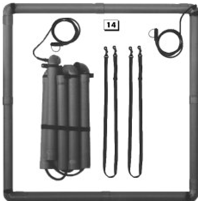
Слика 29. Склопљена и расклопљена сонда димензија 1 x 1 метар састављена од 8 елемената (цеви), са платненим тракама за ношење.
