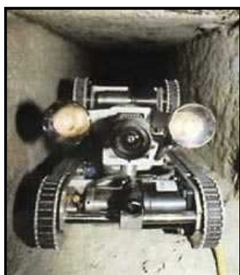
Upuaut - Specijalno dizajniran robot za istraživanje okna
